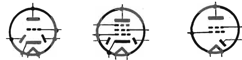
Fig. 1 - Simboli elettrici di tre diverse valvole rivelatrici e preamplificatrici montate in radiorecettori di più o meno vecchia produzione e di classe differente.
